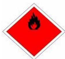
GAZ DU LIQUIDE INFLAMMABLE
